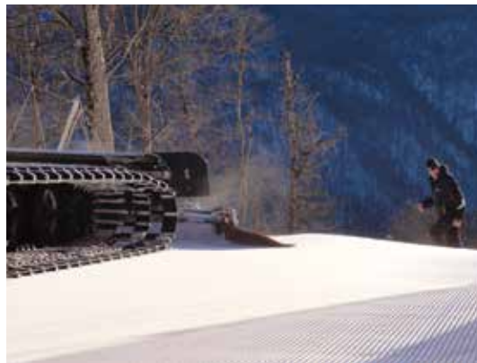
Fresen fordeler og blander snøen før den blir presset i fine riller. Dybde, trykk og hastighet på fresen justeres etter ønsket resultat.
