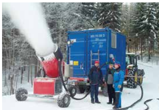
Flyttbare system med kanoner og aggregat er mest anvendt i mindre anlegg og langrennsanlegg.
