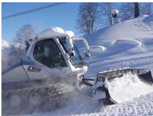
Frontskjæret flytter store mengder snø og grovfordeler den til ønskede steder.
