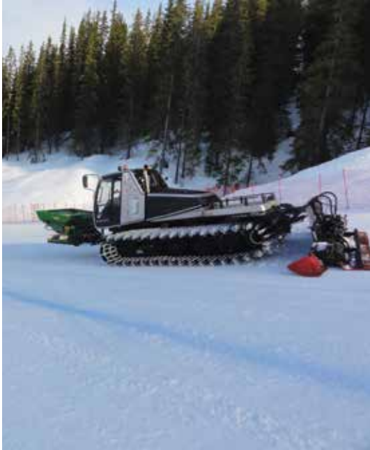
Frontmontert saltkasse på prepareringsmaskin gir mulighet til rask og jevn grunnsalting opp til 40 m bredde i renntrasé og vårsnø for normal skikjøring.
