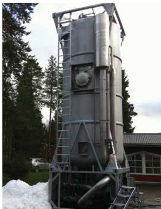
Eksempel på separator i snømaskin som kan operere uavhengig av temperatur.
