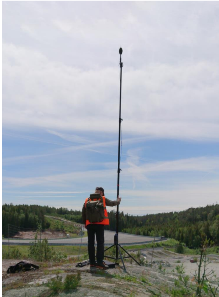
Figur 5: Måling av støy ved Rudskogen Motorsenter fra et høydepunkt. Foto: Knut Iver Skøien
