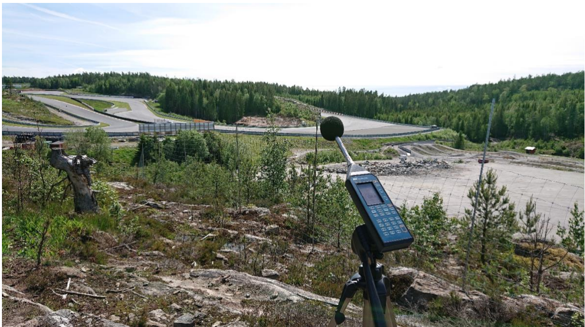
Figur 4: Måleinstrument for støy. Foto: Knut Iver Skøien
