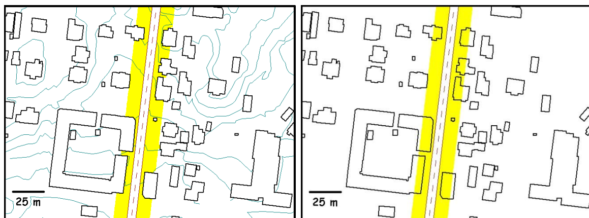
Figur 76. Rød og gul støysone - lite trafikk. Komplette nordisk beregningsmetode i figur til venstre, sjablongmetode i figur til høyre.
