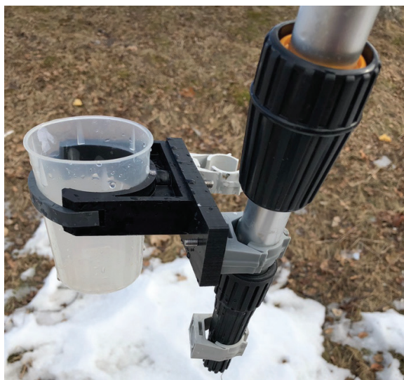
Figur 10: Bildet viser endestykket på teleskopstangen med feste til prøvekop, og sprøytefeste i bakgrunnen, som ble benyttet til prøvetaking. Foto: Marit N. Haugen 04.04.18
