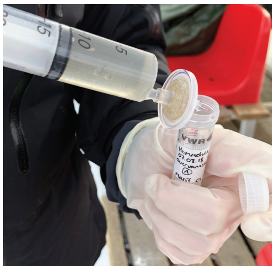
Figur 11: Bildet viser prosessen for prøvetaking i felt, hvor vannprøve sprøytes gjennom filter og over i prøverør for ICP-MS. Foto: Marit N. Haugen 07.03.18
