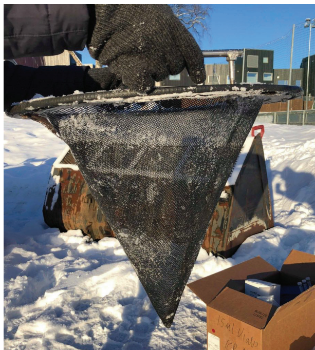
Figur 5: Bildet viser filter (siftr) som det er mulig å installere i kummer rundt en kunstgressbane. Dette filteret er installert i kum på Dalgård kunstgressbane. Foto: Marit N. Haugen 13.02.18
