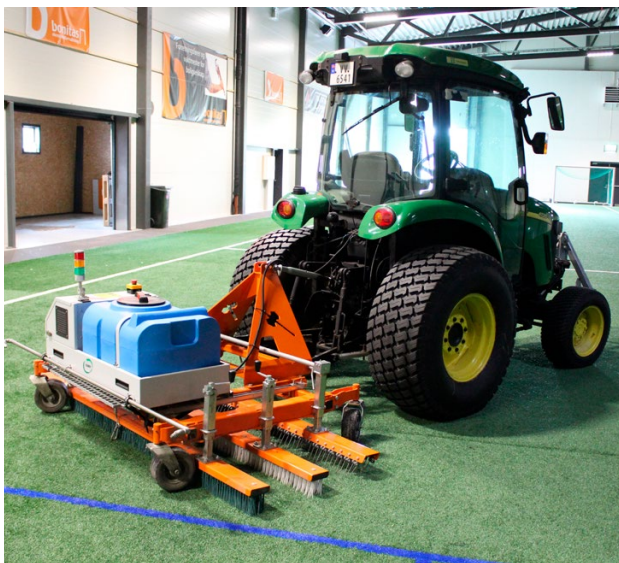
Foto 26 Prøverigg rengjøring kunstgress (Foto Bjørn Aas)
