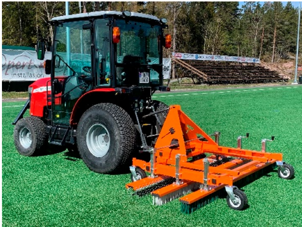
Foto 11 Lett traktor med børste/harv HB240 (Parkmaskiner 2022)
