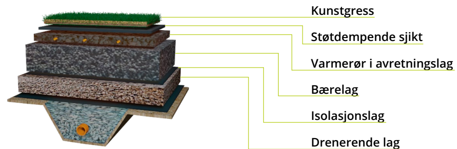
Figur 21 Oppbygging kunstgressflate (Skjevdal, Blikra 2021)
