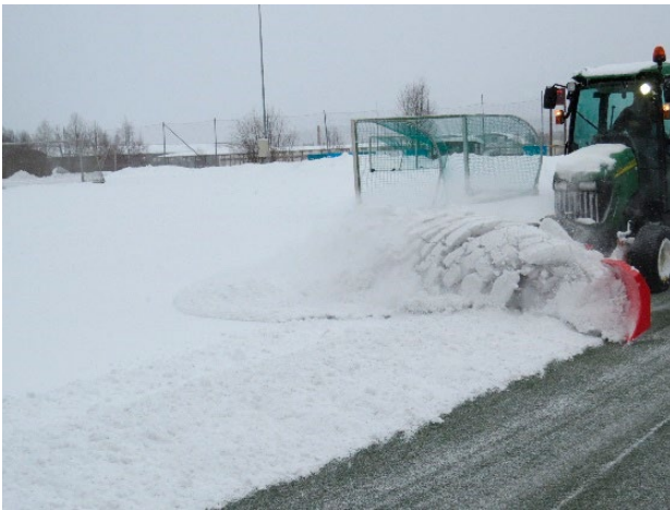
Foto 8 Snøfjerning med skjær (Foto: Parkmaskiner)
