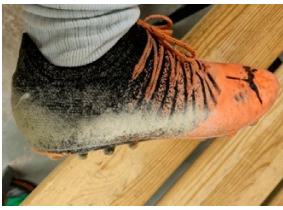
Foto 19 Plaststøv fra ifyll (SIAT2020)
