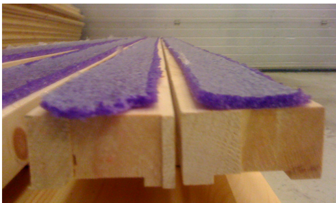
Figur 25: Dempningsmateriale på lekt for testgulv 2
