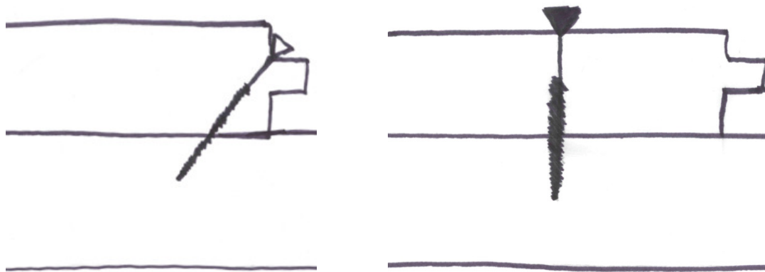
Figur 21: Illustrasjon av skråstilt og rett skruer gjennom gulvbord og lekt
