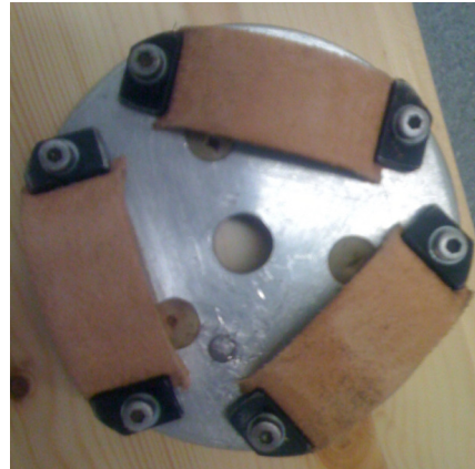
Figur 32: Nedre del av testapparatet Figur 33: Foten av momentcellen som er i kontakt med prøvelegemet
