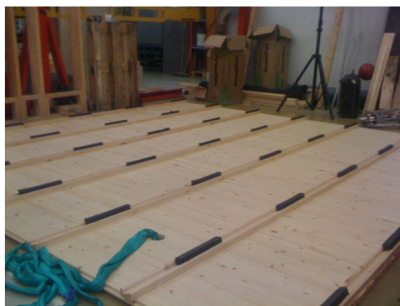
Figur 22: Testgulv 1b med fordelte felter med Armaflex
