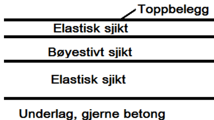
Figur 7: Prinsippsskisse kombielastisk konstruksjon
