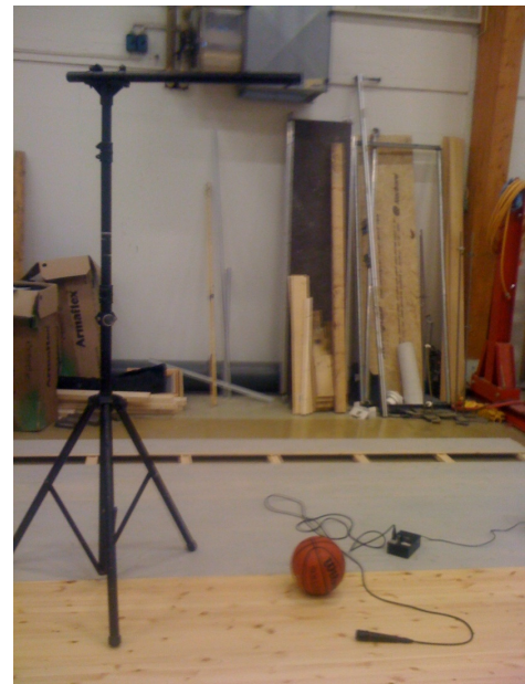
Figur 36: Oppstilt utstyr for måling av spretthøyde
