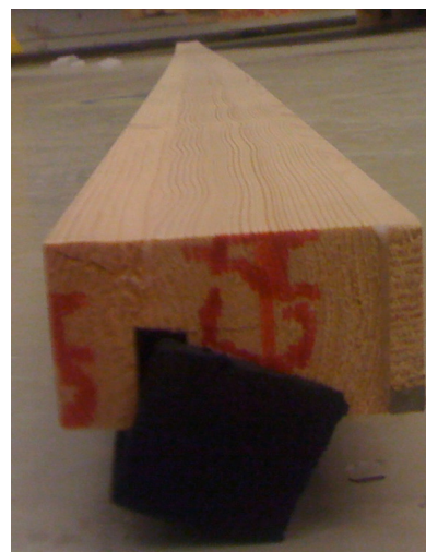
Figur 19: Lekt med 32 mm tykk armaflex
