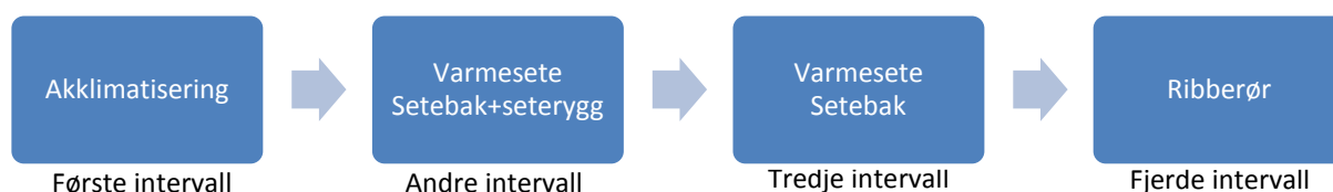
Figur 23: Fremgangsmetoden for testen. Testen ble utført over fire intervaller på 15 minutter.
