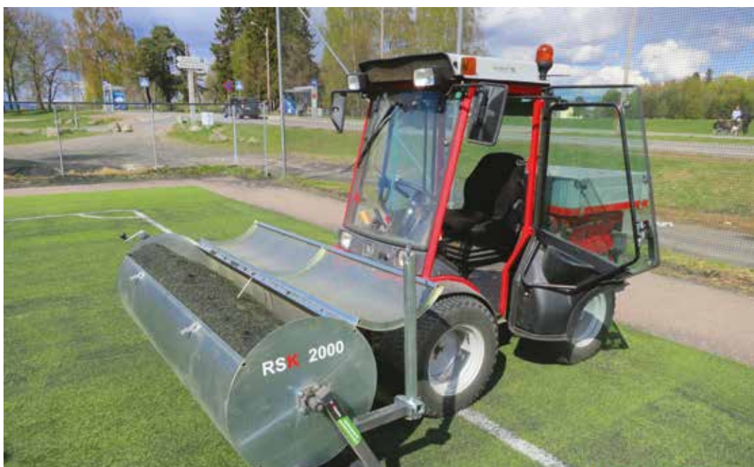
Utlekking av oppsamlet granulater
