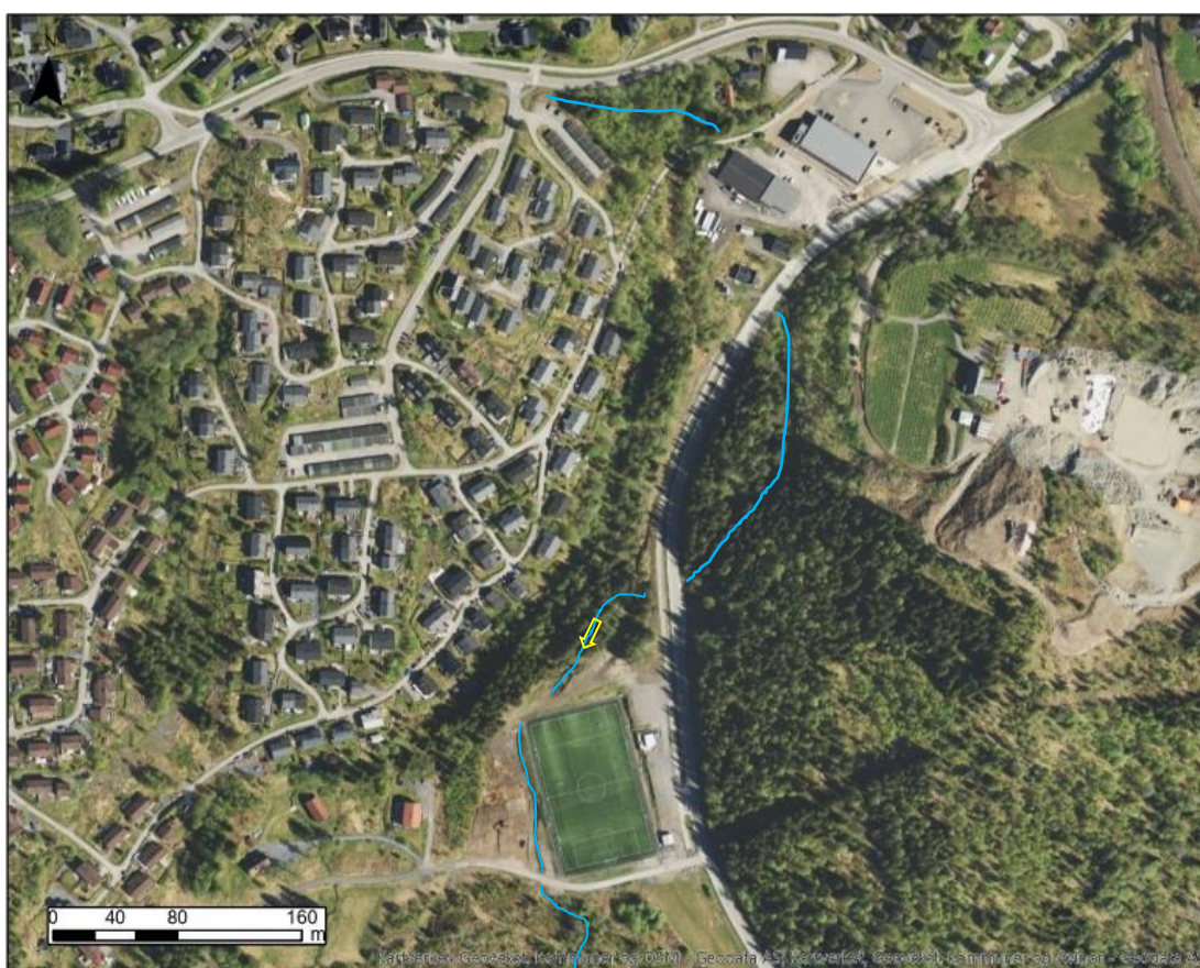
Figur 11: Flyfoto fra Granly. Grønne linjer viser til bekker i området, piler viser strømningsretning. Oransje linje viser hvor bekken ligger i kulvert. Kartgrunnlag: Statens kartverk, Geovekst og Nittedal kommune.
