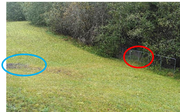
Bilde 22: Prøvepunkt Kurland 6 (rød-sirkel) sidebekk (nedstrøms). Bildet er fra prøvetakingsrunde 3, 28.9.2020 med stor vannansamling (stående vann). Til venstre i bildet sees granulater på grøntarealet ned mot bekken (blå sirkel).
