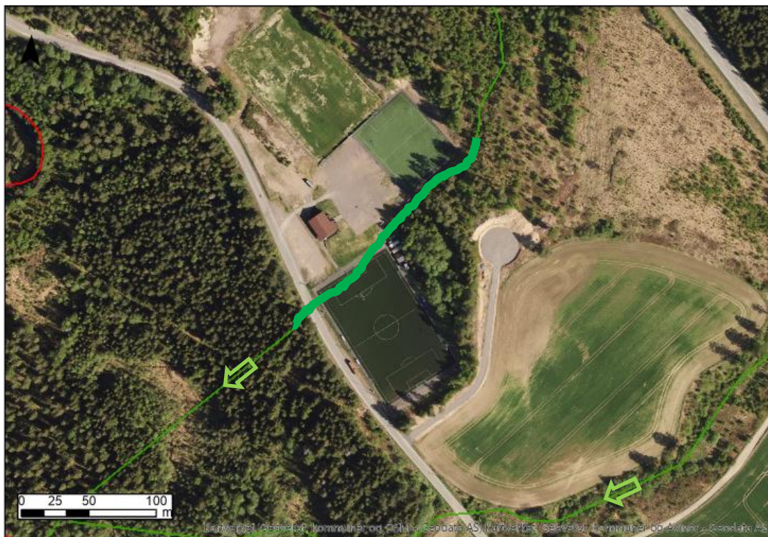
Figur 8: Flyfoto fra Slettmoen. Grønne linjer viser til bekker i området, piler viser strømningsretning. Tykk grønn linje viser til hvor bekken ligger i kulvert. Kartgrunnlag: Statens kartverk, Geovekst og Nittedal kommune.
