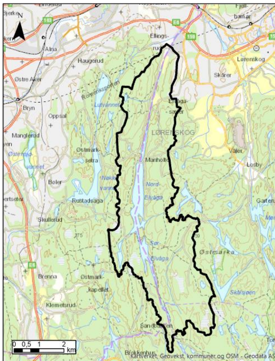
Figur 3: Nedbørsfelt for Ellingsrubekken v/Ellingsrudåsidrettspark, hentet fra nevina.nve.no. Kartgrunnlag: Statens kartverk, Geovekst og Oslo og Lørenskog kommune.
