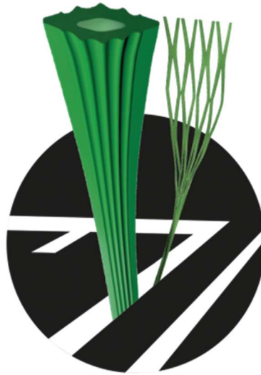
Figur 1: Forskjellen på mono (venstre) og splittfilm fibre (høyre) (19).
