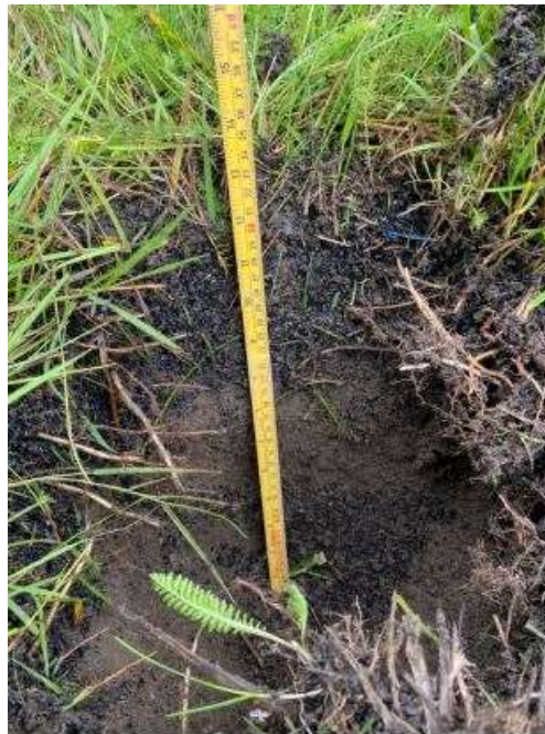
Figur 8: Kontaminert jord som følge av spredning av granulat fra kunstgressbane (69).
