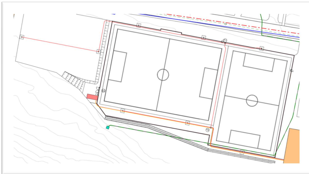
Figur 17: EL-plan for prosjektet med tilførsel til lysmaster og varmesentral.
