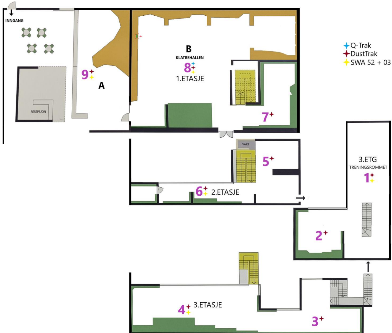
Figur 8. Plassering av måleinstrumenter på Torshov
