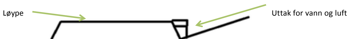
Figur 2-1: Illustrasjon på hvordan rulleskiløypa er bygd opp i dag (Wirgenes, Alvestad et al. 2015).
